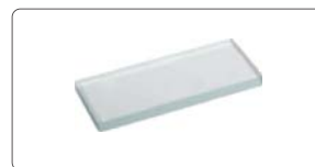
50mm读数尺(选配, 检查放大精度)
